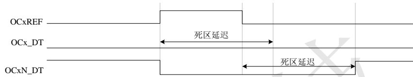
Figure 106 死区时间大于 OCxREF 无效电平宽度时的死区插入
