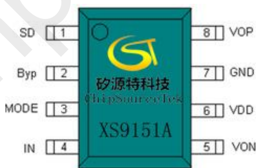
图 2 XS9151A 管脚定义
