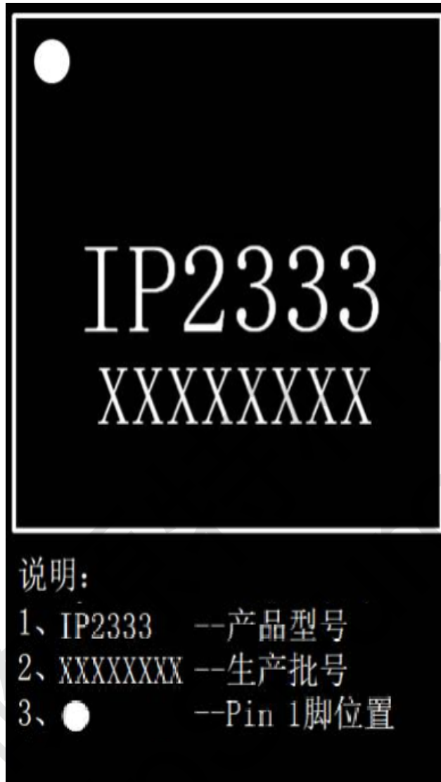
图 14 IP2333 IC 丝印说明
