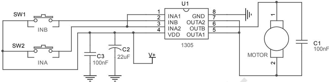
**注意：**在不同的应用中，C2、C3 可考虑只装一个：在 3V 应用中建议用一个 1uF 或以上；在 4.5V 应用中建议用一个 4.7uF 或以上；在 6V 应用中建议用一个 10uF 或以上；在 7.2V 应用中建议用 22uF 或以上，均为使用贴片电容靠近 IC 之 VDD 管脚放置且电容的负极和 IC 的 GND 端之间的连线也需尽量短如下图。即不要电容虽然近，但布线、走线却绕得很远。另外当使用大电解插件电容时，建议再按以上规则并一个 100nF。当应用板上有大电容在为其它芯片滤波时且离 TC1305 较远也需按如上要求再放置一个小电容于 TC1305 的 VDD 脚上。图中 C1 若不能焊在马达上，则将其设计在 PCB 上。
