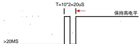
3、芯片切换到D类无防破音模式波形：
