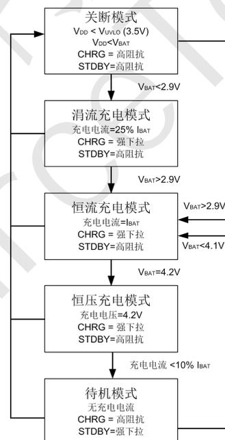
图 3: 4.2V 电池典型充电循环的状态图
