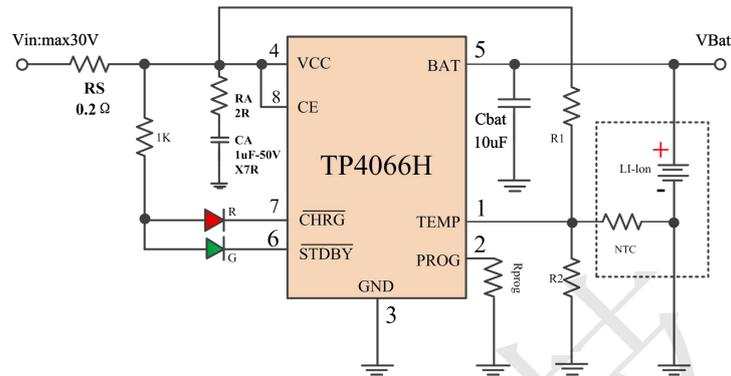
注：输入端 CA 电容,耐压选择输入最高电压 1.5~2 倍;如不使用 TEMP 功能，该引脚需接地。
